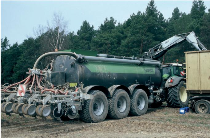
Am Feldrand ist ein Spezialcontainer für die Zwischenlagerung der Biogäsgülle aufgestellt. Das Strip-Till-Gerät und Güllefass können auf dem Feld verbleiben und kontinuierlich arbeiten
