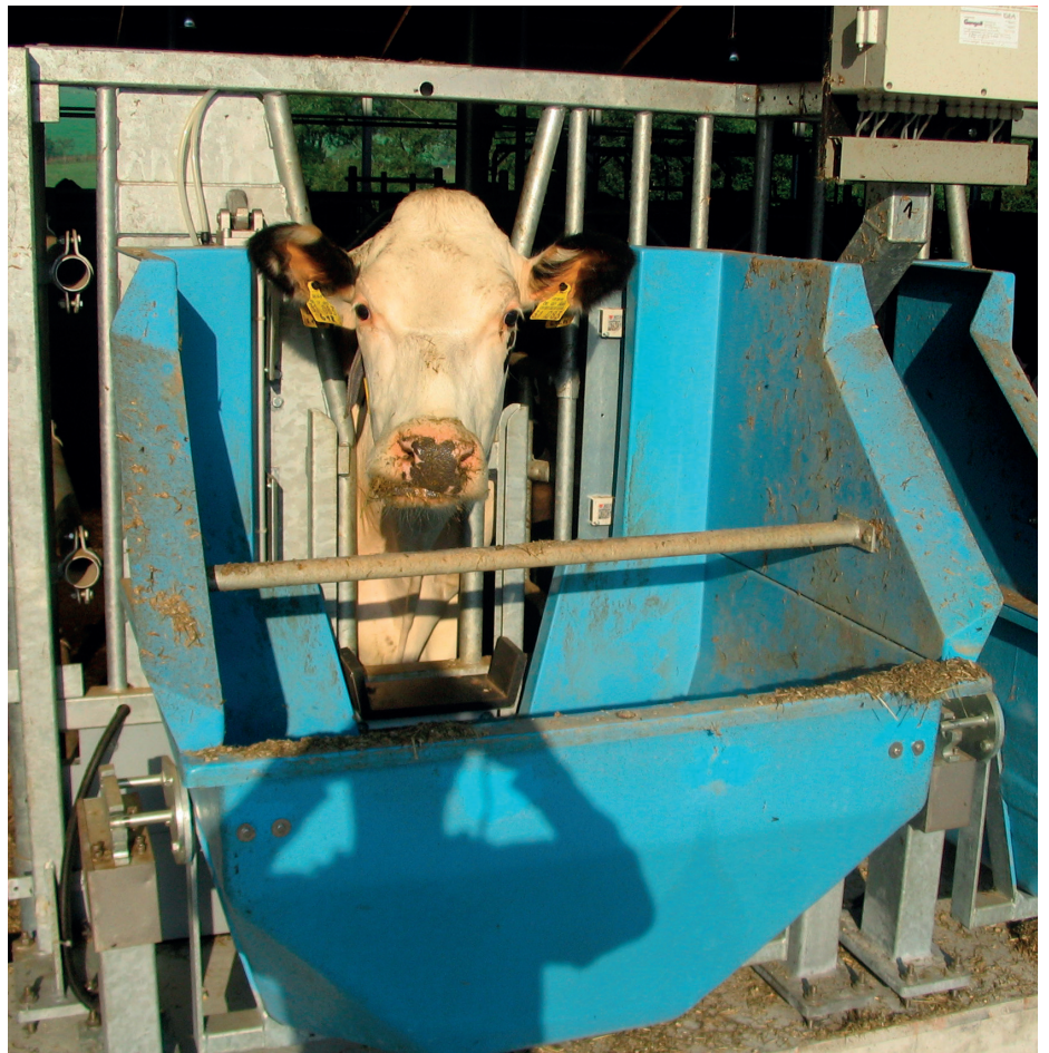
Messvorrichtung zur Dokumentation der tierindividuellen Futtermittelaufnahme
