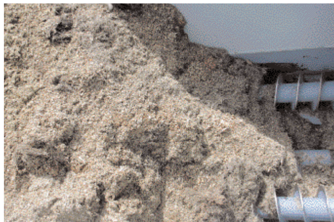
Schnecke im Einspeisetrichter
